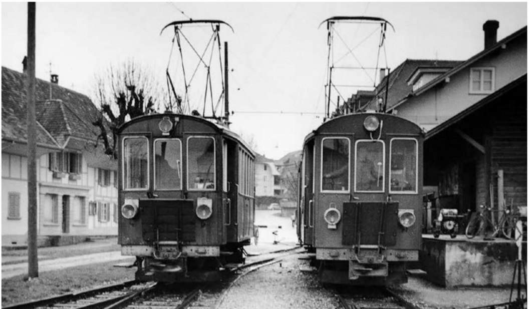
Das fehlende Gepäckabteil wurde mit einer originellen Ladefläche für Milchkannen und andere Waren kompensiert. Hier die Be 2/2 11 und 12 der LJB.
