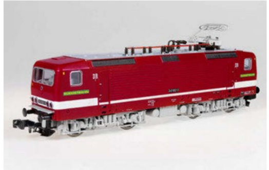
... «Trabbi». Mit der Tauschplatine von AMW sehr leicht zu digitalisieren.
