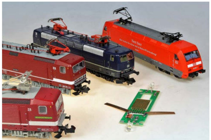
Vier Loktypen – eine Platine: Die Tauschplatine von AMW passt auch noch in andere Roco-N-Loks.
