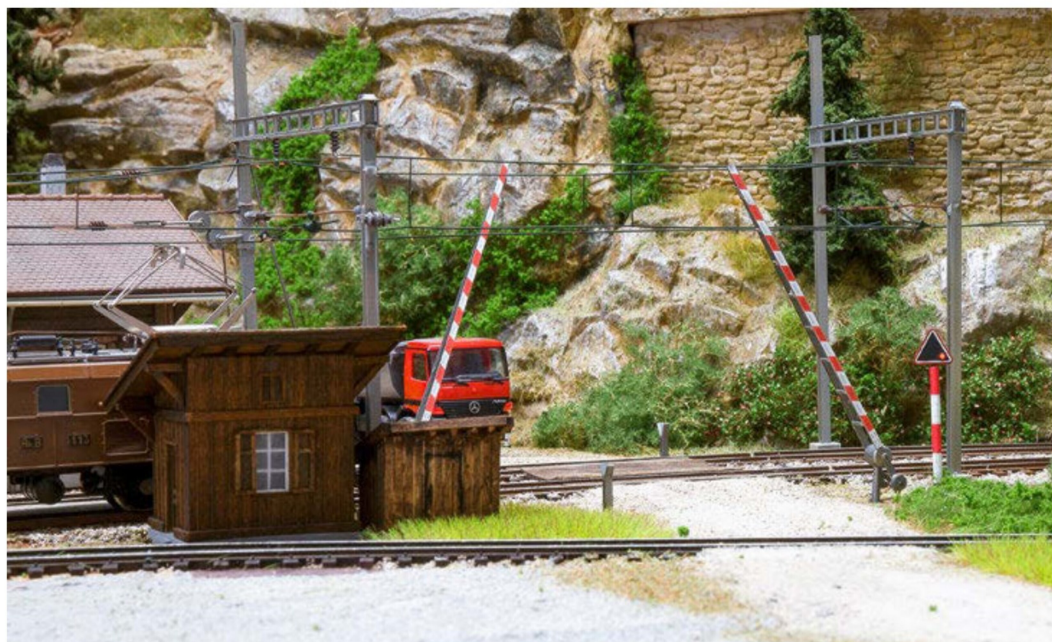
... Anlagensteuerung eingebunden. Die Schranken schliessen sich erst, nachdem die Wechselblinker und die Glocke auf den Zug aufmerksam gemacht haben.
