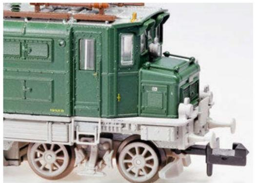
Die Ae 3/6<sup>1</sup> 10616 gehörte zum ersten Baulos und hat ein verkürztes Dach sowie Sonnenblenden oberhalb der Führerstandsfenster. Diese Version wurde von Piko bis jetzt noch nicht produziert, es handelt sich also um eine Formvariante. Passende Wagen dazu beinhaltet das ebenfalls als Neuheit angekündigte SBB-Oldtimerwagensem (Art.-Nr.: 05.94344).
