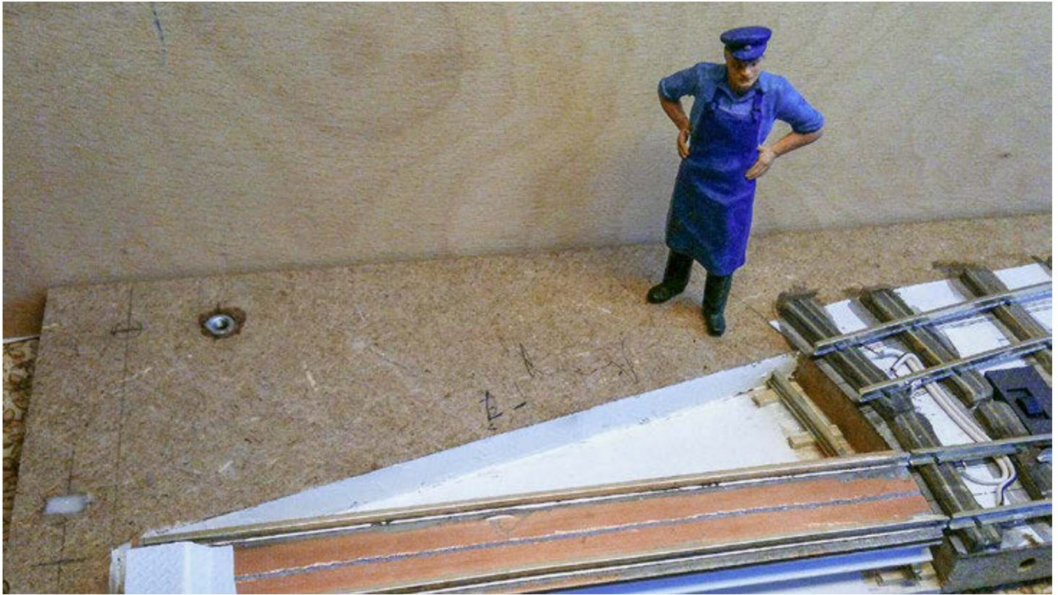
Der Unterbau der Segmentdrehscheibe besteht aus einer Pertinaxplatte, mittels eines kleinen Elektromotors mit Getriebe kann sie verstellt werden.
