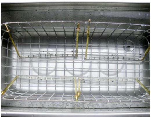
Nach dem Zusammenlöten werden die Masten im Ultraschallbad gereinigt.
