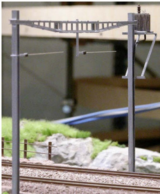
Ein weiterer Sonderfall: ein Masttrafo an einem Oberleitungsjoch.
