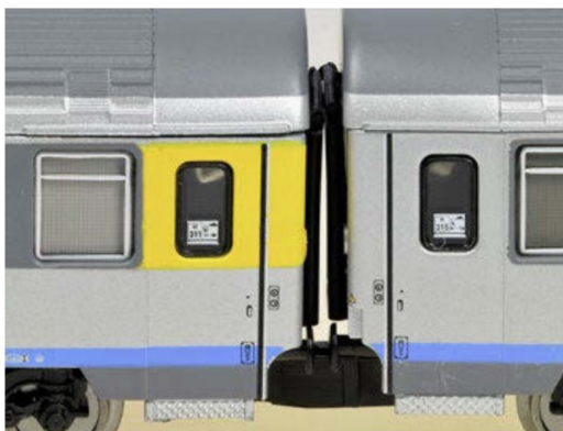
Von Haus aus enge Kuppelabstände lassen den Einsatz von Kurzkupplungen ...
