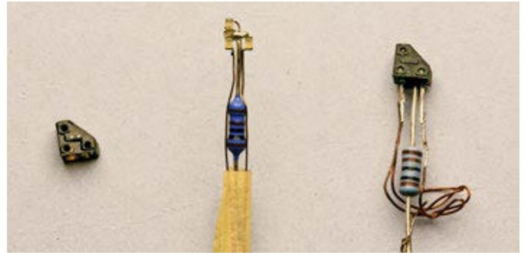
Selbst gebaute Zwergsignale: lackiertes Gehäuse, Innenleben mit 3 LED und Vorwiderstand, einbaufertiger Zwerg (von links).
