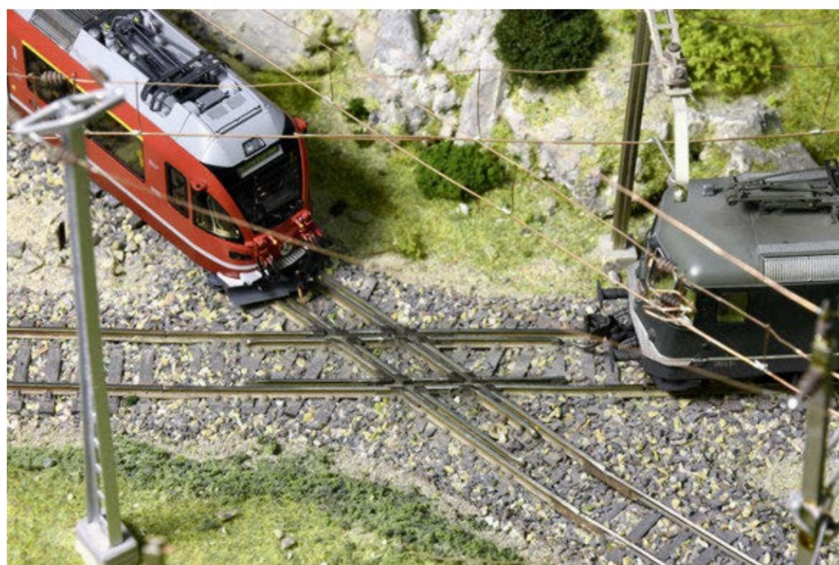
Vor dem Bahnhof Burgfelden kreuzen SBB und RhB niveaugleich. Bis zur Digitalisierung der RhB-Strecke werden Zugkollisionen durch eine Lichtschranke verhindert.
