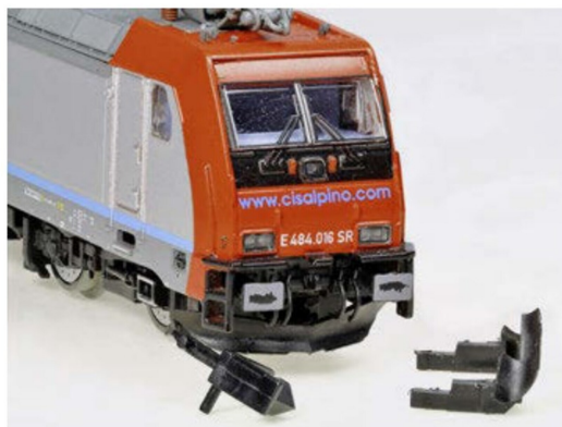
Geschlossener Schienenräumer; Kupplungshaken und Schläuche montiert.
