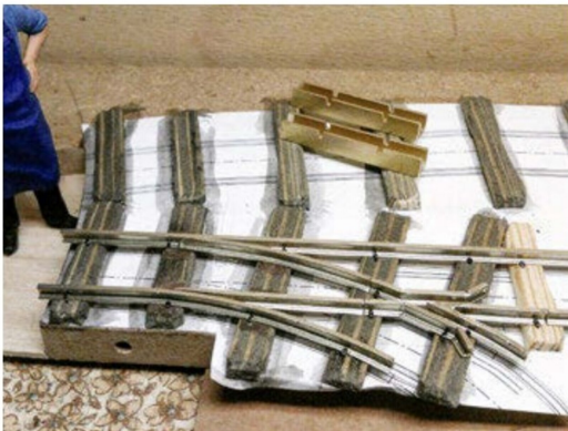
Die gesamte Weiche mit selbst gebauten Spurlehren aus Messing.
