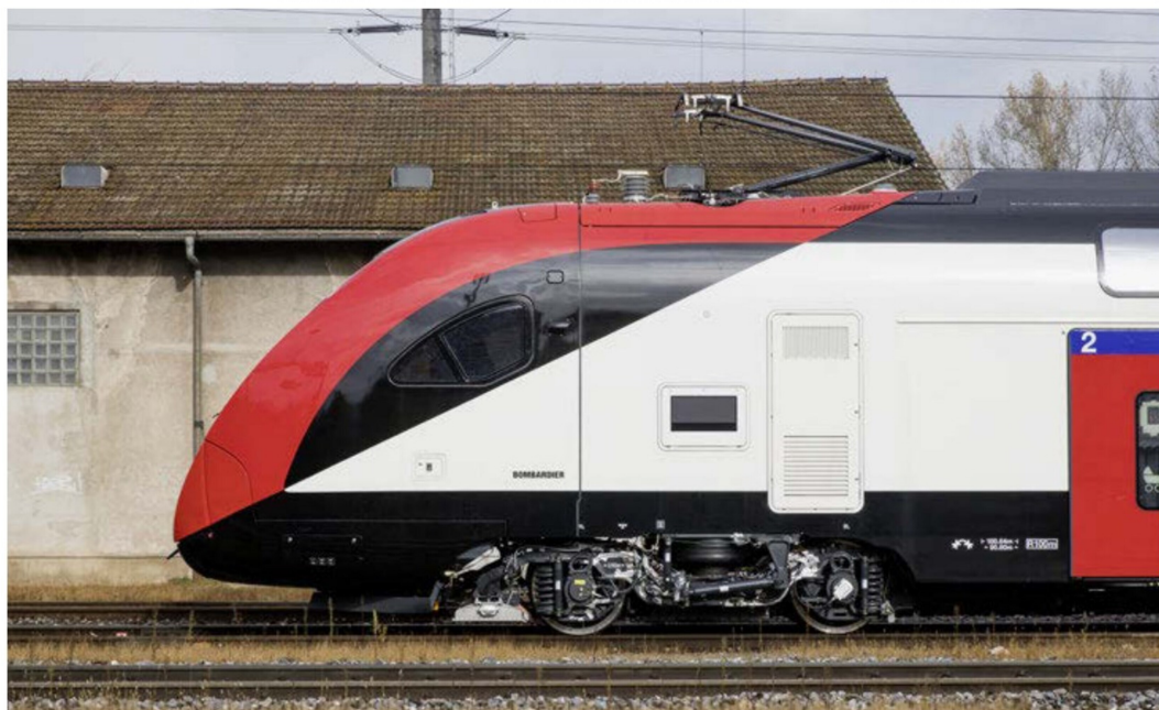
Im Profil sind die dynamische Form der Front und das mit Zugsicherungsmagneten ausgestattete Antriebsdrehgestell gut sichtbar.
