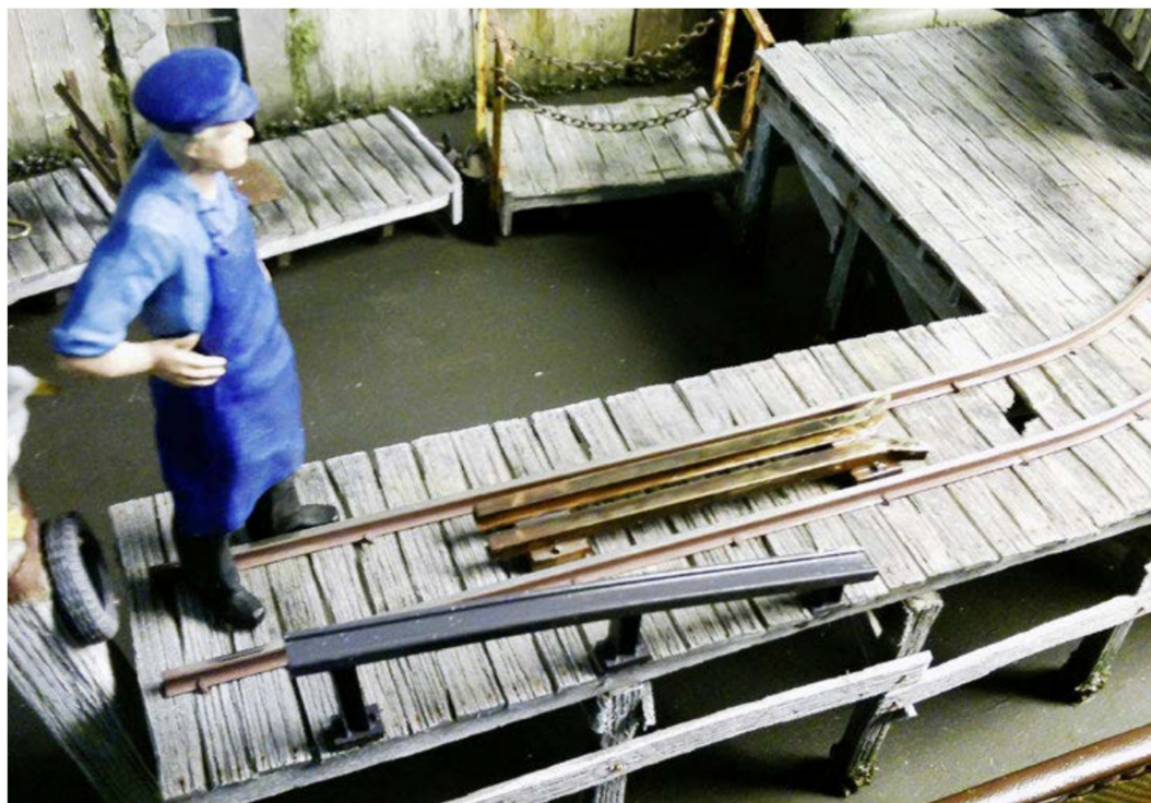
Der Kippmechanismus für den Wagen: Eine Klemmschiene verhindert das Umfallen des Wagens, eine Rampe hebt den Entlademechanismus an.
