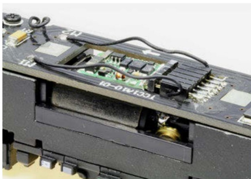
Die alte Schnittstelle nach NEM 651 lässt nur die Grundfunktionen zu.
