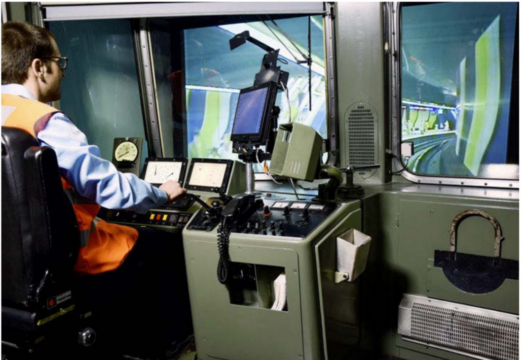
Blick in den Re-4/4 II -Führerstand. In der Bildmitte ist der Lokführer Electronic Assistant (LEA) zu sehen.
