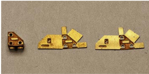
Selbst gebaute Zwergsignale: Gehäuse vor und nach dem Falten der geätzten Messingbleche.
