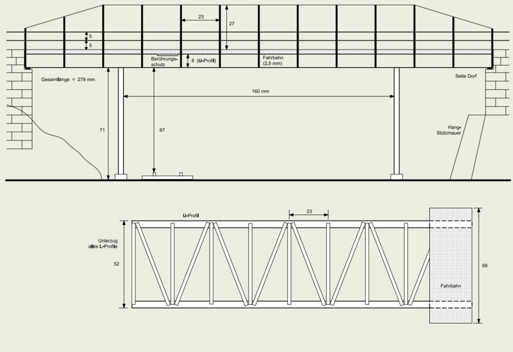
Planung ist die halbe Miete. Zeichnen, zeichnen, zeichnen ... Die Zeichnungen dienen zum präzisen Positionieren aller Bauteile der Widibrücke ...
