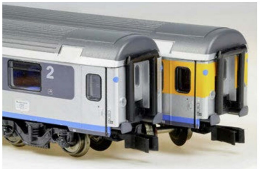
Wir haben die Wagen mit den Kurzkupplungen von PEHO ausgerüstet.
