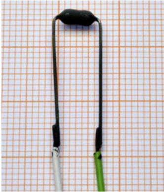
Ein Indikator in Originalgröße auf Millimeterpapier mit den werkseitigen Anschlussleitungen aus Litzendraht.
