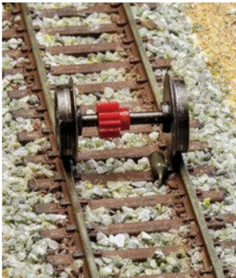
Der Abstand eines Lokomotiv-Antriebsradsatzes zum Indikator soll für eine korrekte Funktion etwa 1 mm betragen.
