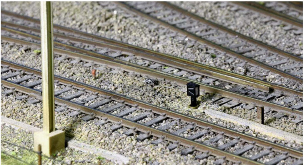
Die Gleisanlage des gesamten Gleisfeldes im Bahnhof Katzenbach ist noch mit Weichenlaternen für die Fahrweganzeig ausgerüstet.
