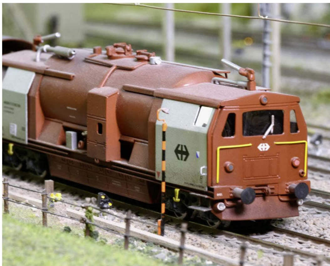
Das Zwergsignal zeigt «Fahrt mit Vorsicht». An der Gegensprechanlage können die Rangierarbeiter Kontakt mit dem Stellwerk von Wassen aufnehmen.
