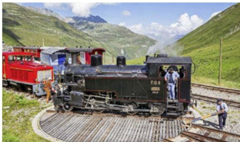
... diese nach einer kleinen Rangierfahrt auf der handbetriebenen Drehscheibe zu wenden.
