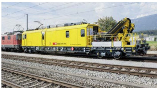
Bei den Rangierarbeiten in Luterbach-Attisholz ist die andere Seite mit dem starken Arbeitskran des Xem 99 85 9181 011-0 gut einsehbar.
