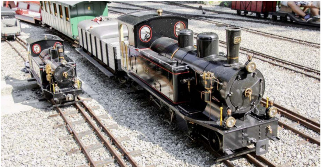
Die Stauffer Anlage ist sowohl für 5- wie auch für 7¼-Zoll Spurweite ausgelegt. Die beiden Brünig-Schwwestern verdeutlichen den Grössenunterschied.
