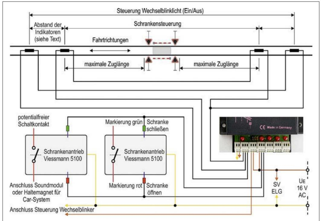
Mit dem ELG-Bahnschrankenbaustein lassen sich nicht nur Wechselblinken und Schrankenantriebe steuern, sondern durch die potenzialfreien Schaltkontakte auch Haltemagnete für Fahrzeuge des Car-Systems beeinflussen. Der Abstand der Indikatoren für Wechselblinken und Bahnschranken sollte bei vorbildähnlichen Verhältnissen etwa 50 Zentimeter betragen.
