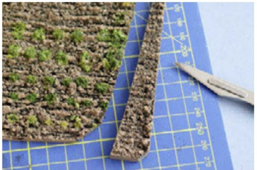
Der Hartschaum ist mit einem Cutter gut zu schneiden. Es wirkt besser, wenn die Kanten nicht rechtwinklig abgeschnitten werden.
