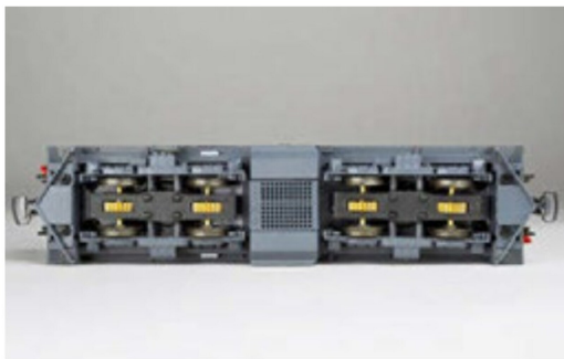
Alle Achsen sind angetrieben und verfügen über Messingzahnräder.
