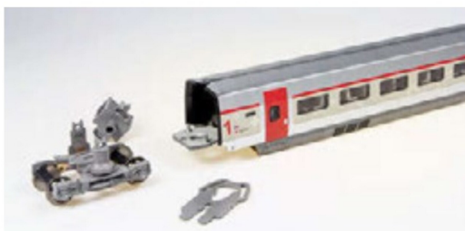
Nach Abnahme des Faltenbalgs kann das Drehgestell entfernt werden.
