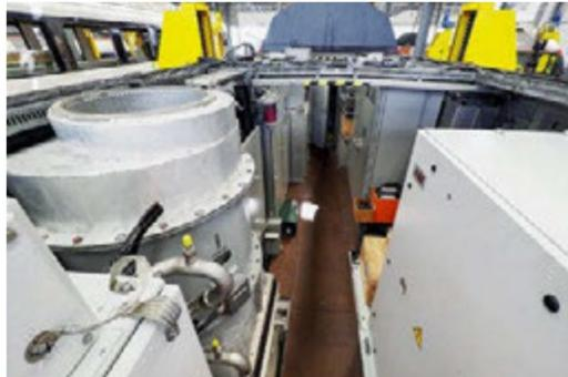
Blick in den vom Dach befreiten Maschinenraum der 460 010. Links der eine Lüftungsturm, rechts einer der beiden neuen, kleineren Stromrichtercontainer.
