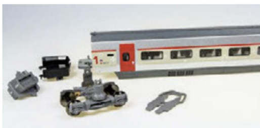
Die schwarzen Kunststoffblenden halten Boden und Gehäuse zusammen.
