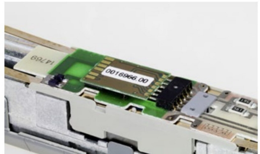
Die Digitalschnittstelle nach NEM 651.
