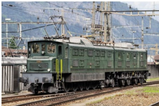
Bis heute imposant im Auftreten ist die aus dem Jahr 1931 stammende von SLM Winterthur und BBC Baden gebaute Ae 8/14 11801.
