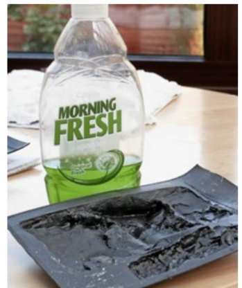
Bevor man das Pulver für die zu gießende Felsmasse mischt, wäscht man mit Vorteil die Gummiform mit Wasser und etwas Zugabe von Waschmittel. Das hilft, Luftblasen an der Oberfläche zu vermeiden.
