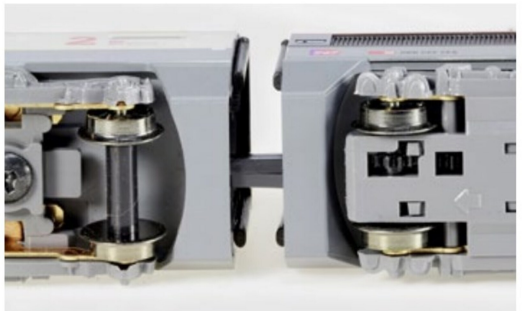
Die Kupplungssituation von unten.
