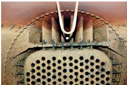
Feuerbüchse mit den Deckenankern nach der Demontage der Siederohre.
