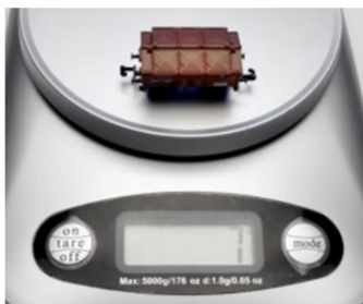
Mit seinen 7 g entspricht dieser Fleischmann-N-Spur Klapptopfwagen genau der NEM.
