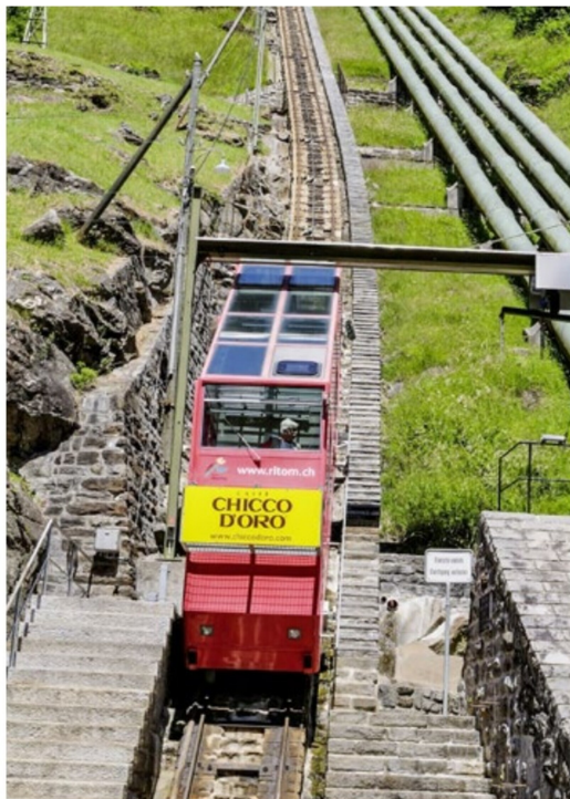
Die Ritom-Seilbahn wurde für den Bau des SBB-Kraftwerkes 1921 gebaut und verläuft neben den Druckrohren.
