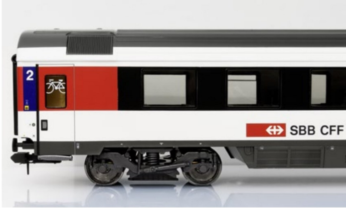
Einstiegspartie eines Bpm61, die Details wurden im Druckverfahren realisiert.
