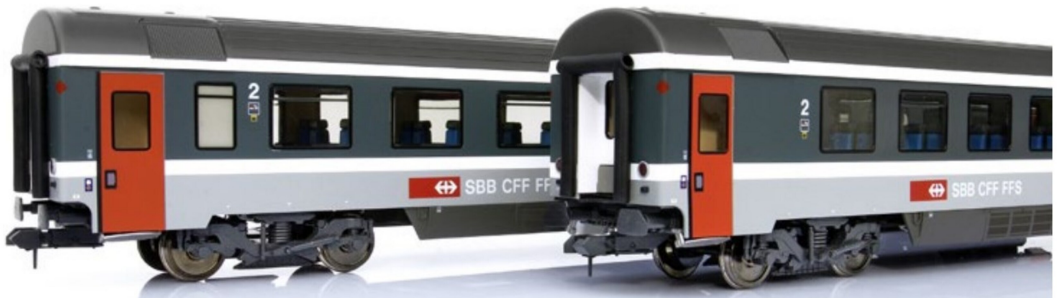
Die Unterschiede zwischen den massstäblichen Wagen (links) und der verkürzten Version (rechts) sind, wenn überhaupt, am Wagenende am augenscheinlichsten.
