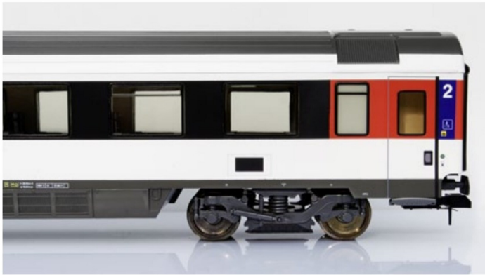
Drehgestelle mit MG-Bremse und Schlingerdämpfer, auf allen Achsen sind Scheibenbremsen angebracht.
