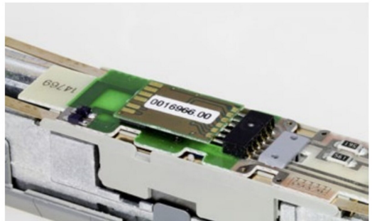
Die Digitalanschnittstelle nach NEM 651.
