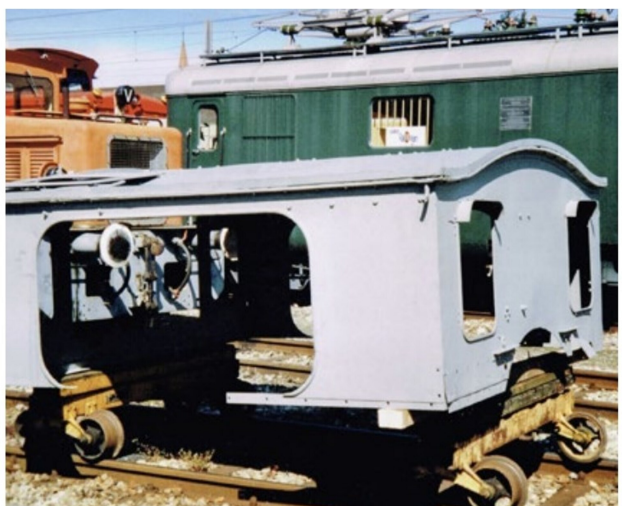
... oder das Führerhausoberteil mussten ganz oder teilweise neu gefertigt werden.
