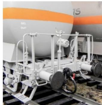
Von diesem zweiachsigen Kesselwagen standen beim Vorbild bis Anfang 2000 zwei Wagen in Betrieb. Diese dienten dem Transport von flüssigem Stickstoff. Das Fassungsvolumen der Kessel betrug 21 245 Liter und der Achsabstand 4,85 m.
