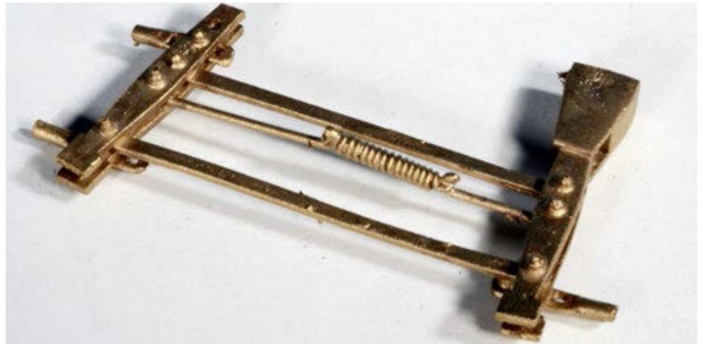
Gussteil für die Bremsschere.
