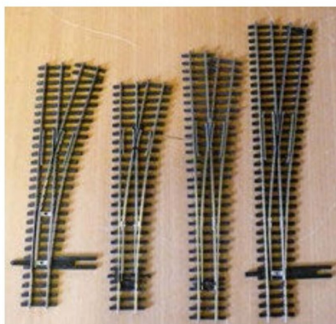
Links eine Nr.-4-Weiche von Shinohara, daneben eine Peco-Weiche (etwa Nr. 5), dann Nr. 6 von Micro Engineering und schliesslich eine Nr. 6 von Shinohara, ausgerichtet auf der Höhe des Frogs (Weichenherz). Die Länge der abgehenden Schienen ist nicht für die Nummerierung verantwortlich, sondern die Distanz von Zungenspitze zu Herzstückspitze.
