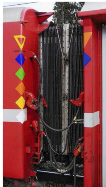
Die vermeintliche Inflation von Eckmarkierungen am RhB DS 4219 soll lediglich testweise erfolgt sein. Massgebend ist nur das obere gelbe Dreieck, das auf die fehlende Türschliessung hinweist.
