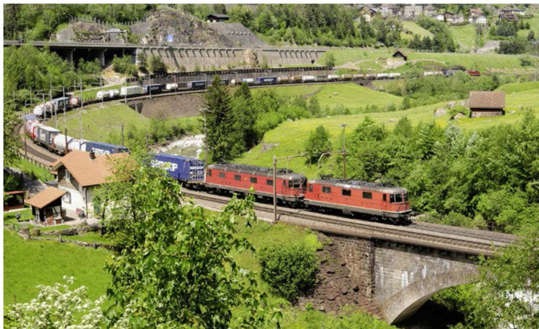
Der Wirtschaftsweg oberhalb der südlichen Einfahrt des Wattinger Kehrtunnels macht den Blick auf die ganze Zuglänge samt schiebender Lokomotive möglich: Re 4/4 11325 mit Re 6/6 11685 «Sulgen» und Re 4/4 11163 am Zugschluss.
