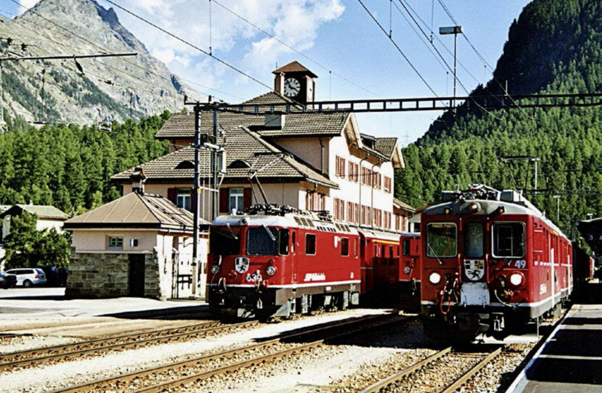
Wechselstromzug nach Samedan am Hausbahnsteig und eine Bernina-Komposition auf Gleis 3 unter gleichgerichteter Spannung von 1000 Volt.
