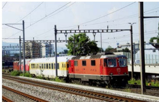
Funkmesszug 99452 auf der Basler Rheinbrücke mit Re 420 11153, Messwagen der DB, geschleppter Diesellok DB 218 466 und Re 420 11116 am 7. Juni 2016.
