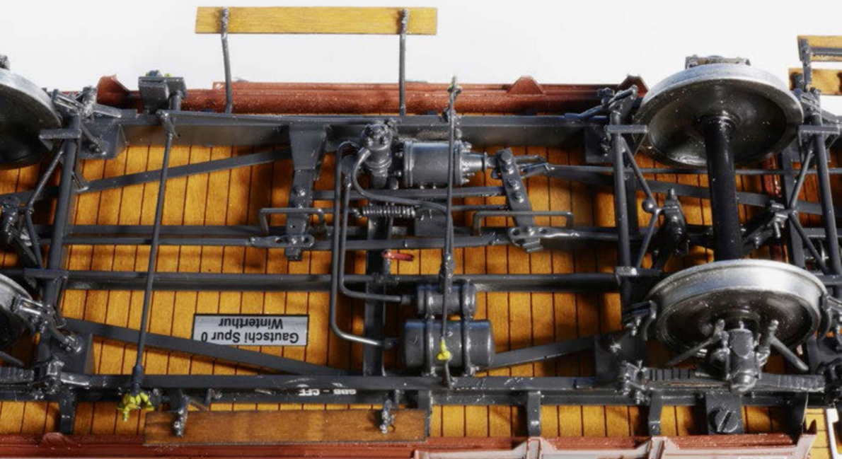
Die Bremsapparate im ganzen Wagenboden des K2 werden im Modell nachgebaut.
