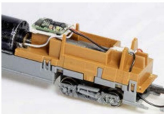
Die Kabelführung nach hinten.
