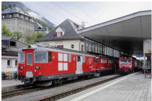
Revidiert und explodiert: Der MGB Deh 4/4 52 erlitt am 8. März, kurz nach der Revision, zwei Explosionen, die zu grossen Schäden führten. Sichtbar an den geborstenen Frontscheiben und am verbogenen Seitentor. Am 20. Mai bringt die RhB Ge 6/6 703 den Triebwagen ab Disentis zur Reparatur nach Landquart.
