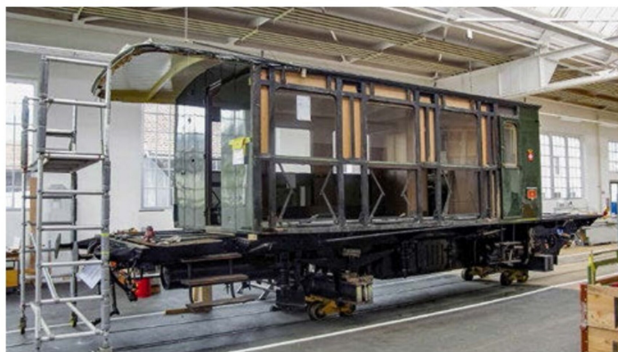
Die beschädigten Blechteile und die Mechanik des CZm 1/2 wurden bereits teilweise entfernt.
