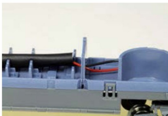
Kabelverlegung im 1./2.-Klasse-Wagen.
