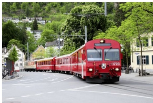
Ge 4/4 II sind seit Jahren vom Plan-Reiseverkehr der Arosalinie praktisch verbannt. Eine Ausnahme bildet der in der Grabenstrasse aufgenommene Zug 1428 vom 10. Mai, der aus einem Verstärkungsmodul und der Lok 622 besteht.
