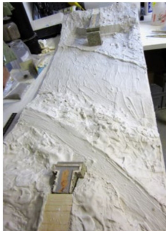
Mit Fliegengitter, Überzug aus Gipsbinden und Gips, wird der Landschaftsuntergrund vorbereitet.
