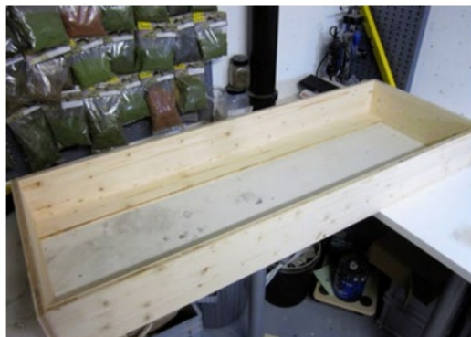
Die stabile Grundlage für die Anlagenteilestücke bildet jeweils ein Kasten aus mehrschichtig verleimtem Fichtenholz.
