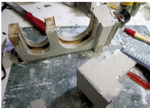
Eine Kartonschablone wird an die Brückenaussenseite angebracht, was das spätere Füllen und Abziehen des Gipses erleichtert.
