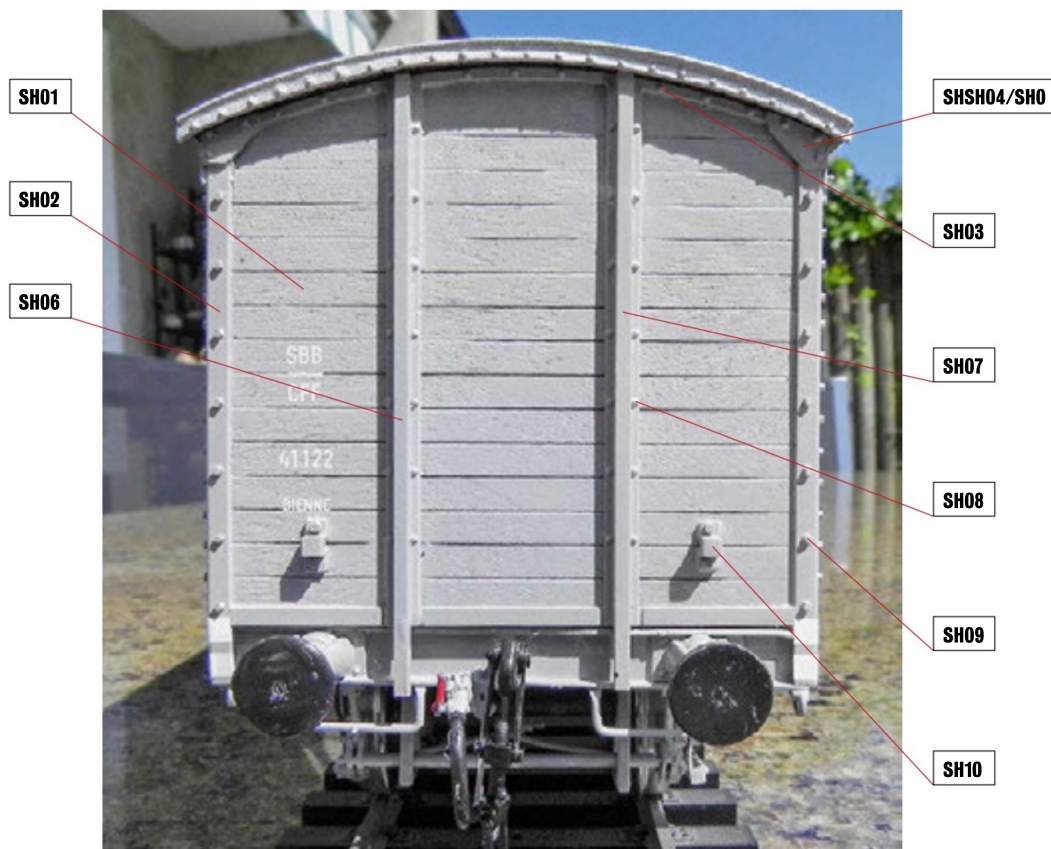
Die Kastenrückwand, hier des grauen K2, mit den Profilen und Schraubenkopfmittungen.
