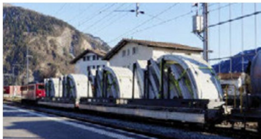
Zug 5157 vom 17. März während eines Kreuzungshalts in Bonaduz. Hinter Lok 707 zwei Re-t-Wagen mit vier «Flats», beladen mit Gewölbeelementen für die Sanierung des Gletscherastunnes bei Bergün. Trotzdem rollen die Wagen planmässig bis Samedan und kehren von dort abends in Dieseltraktion nach Bergün zurück. Die komplexe Transportabwicklung ist ebensolcher Personal- und Betriebsreglementen geschuldet.
