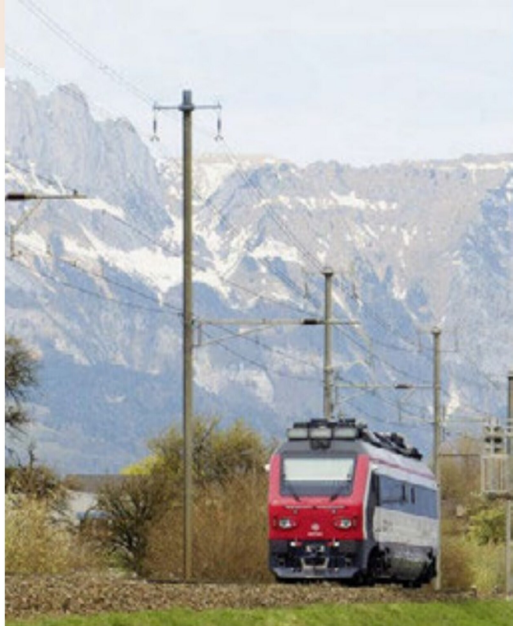
An jenem Tag misst das SBB-Diagnosefahrzeug XTmass 99 85 9 160 001-5 die Betriebsgleise zwischen Chur und Altstätten (SG) – aufgenommen in Sevelen – und danach, wieder via Sargans, bis nach Zürich.
