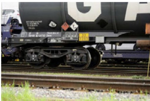
Moderne Zisternenwagen mit neuen Drehgestellen in Patteln. Man beachte die «fehlenden» äusseren Bremsklötze.
