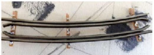
Beim Bahnübergang entstehen mittels Gleisprofilen ein Art Rillenschienen.
