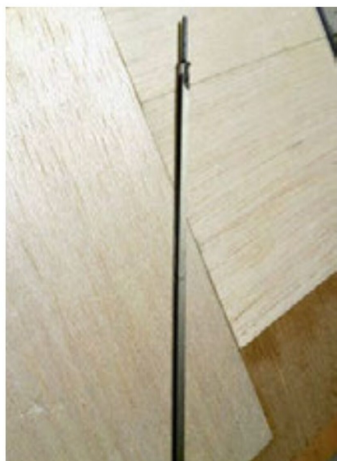
Die M2-Schraube ist im H-Profil hartverlötet.
