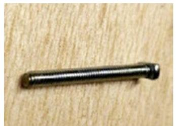
... aus einer M2-Schraube mit bearbeitetem Kopf.
