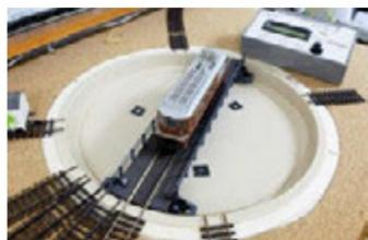
Die vom englischen Hersteller als Bausatz angebotenen Drehscheiben sind ohne elektrischen Antrieb. Dieser kann selbst mit wenigen Bauteilen nach einer beiliegenden Skizze gebastelt werden. Eine wohl günstige, aber doch für den Einsatz auf einer modernen Anlage ungenügend präzis steuerbare Lösung.
