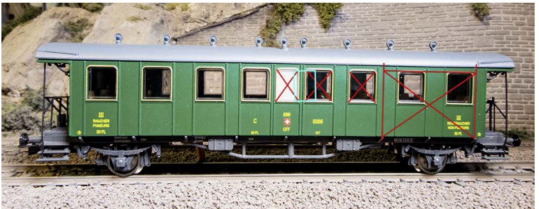
Als Basismodell für den X 9002 dient nun ein Liliput Personenwagen L334472. Auch dieser wurde fotografiert und auf dem Bild die Schnitte eingezeichnet.
