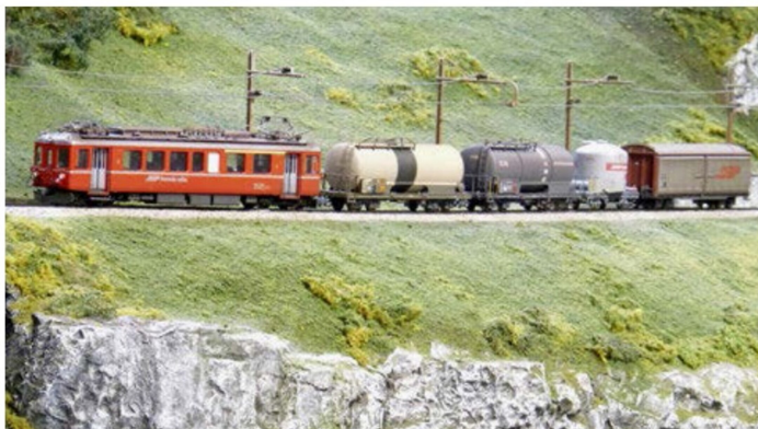
ABe 4/4, 440 kW, 40 t, 40 Plätze, Last: 14 Achsen, 154 t, V max 65 km/h.
