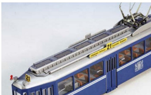
Bemerkenswert: Dachwiderstände und die noch vorhandene Rutenkupplung.
