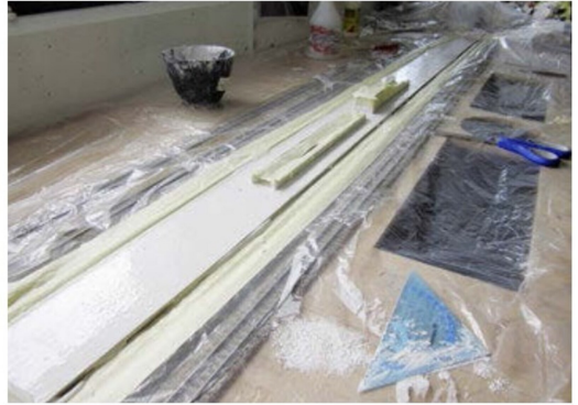
Giessen der Perrons mit Gips/Moltofill-Gemisch und sauber abziehen mit einem Spachtel. Nach Trocknung wird es mit verdünnter Acrylfarbe bemalt.
