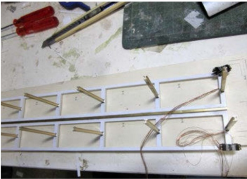
Das Perrondach, auch aus Polystyrol gefräst mit den Anschlüssen für die Signale.
