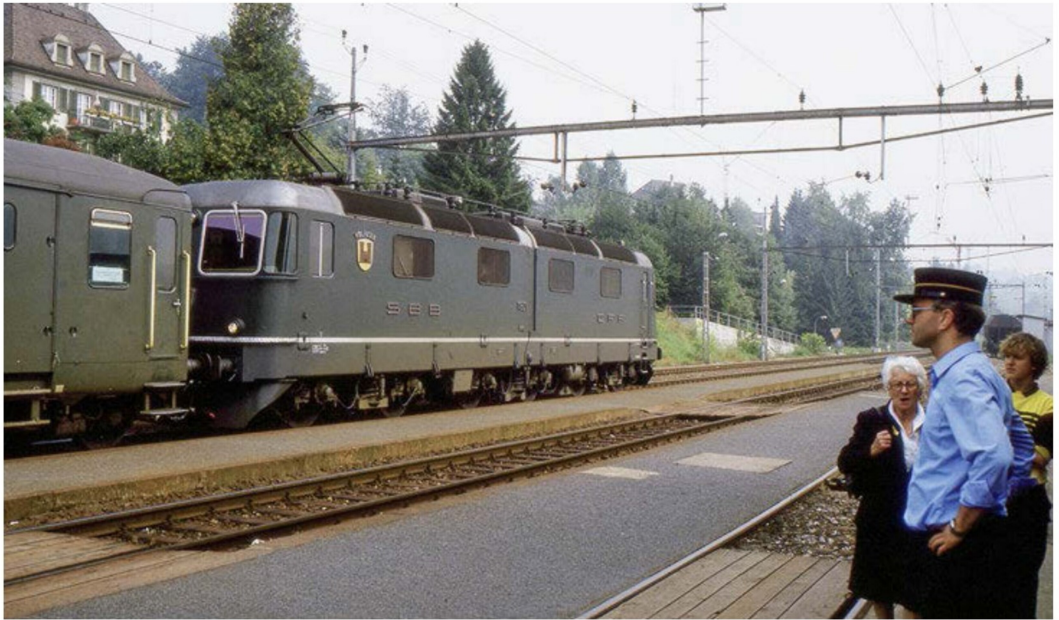
Eine der beiden Prototypen-Maschinen mit geteiltem Lokkasten, Re 6/6 Nr. 11601 «Wolhusen» in Küssnacht in Richtung Gotthard im August 1984.
