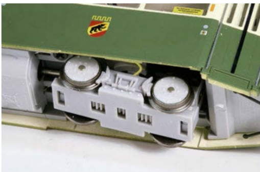
Die Motorwagen sind mit zwei angetriebenen Drehgestellen ausgerüstet.
