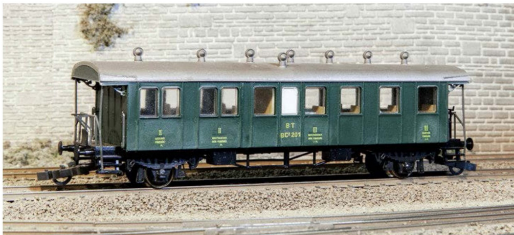
Das Prinzip «Aus zwei mach eins» steht hinter dem Umbau zum BC 2 201. Und zwar aus je einem C 2 und B 2 aus dem Hause Liliput.
