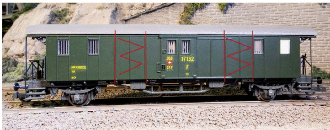
Auf einem Foto des Gepäckwagens aus dem Liliput-Sortiment wurden die Schnittstellen für die Verkürzung aufgezeichnet.
