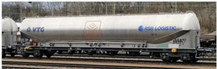
Transportiert wird die Braunkohle in geschlossenen Wagen des Typs Uaens.
