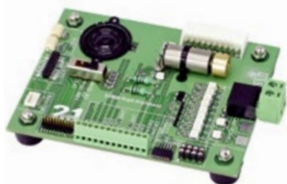
Profi-Prüfstand für Decoder von ESU.
