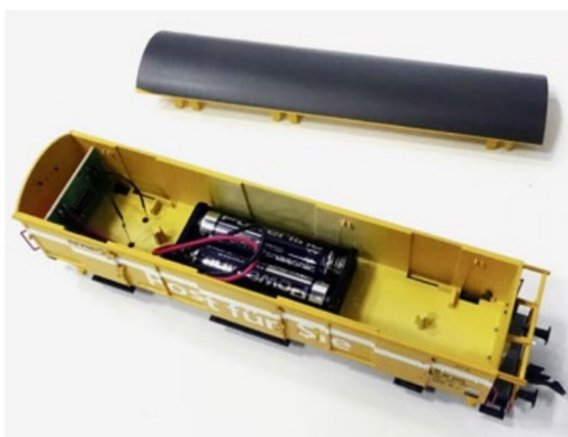
Mit Batterien und Sensor betriebenes Schlusslicht im Postwagen.
